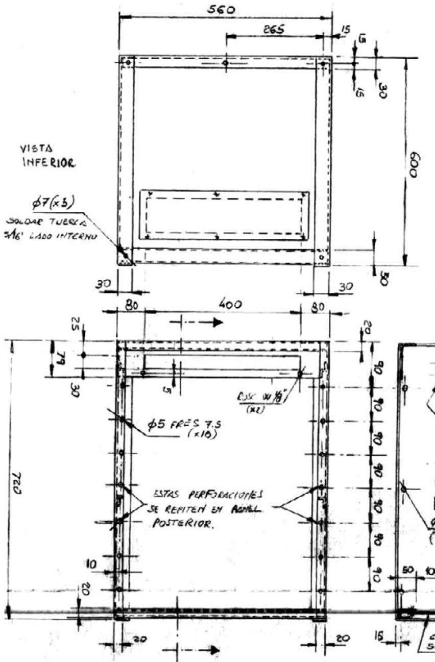
Dimensiones de la base con formato de rack de 19''. Preferiblemente en chapa de acero de 1 mm. Puede también ser realizada en madera revestida en Formica con cantos de aluminio. Si no se necesita el espacio de rack, el frente puede ser reemplazado por una puerta y ser usado para guardar la CPU de hasta dos PCs.
