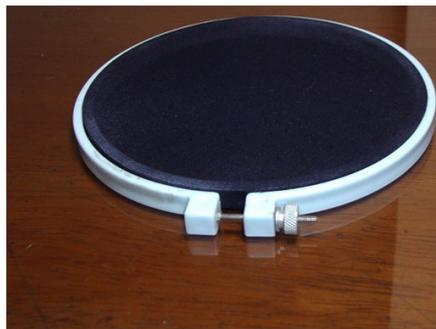
4. Consigue un borde de aluminio, de los que se usan para colocar vidrios (3 dólares). Taladra una de las esquinas, en forma de U, con una broca del mismo diámetro de la tuerca del bastidor.
