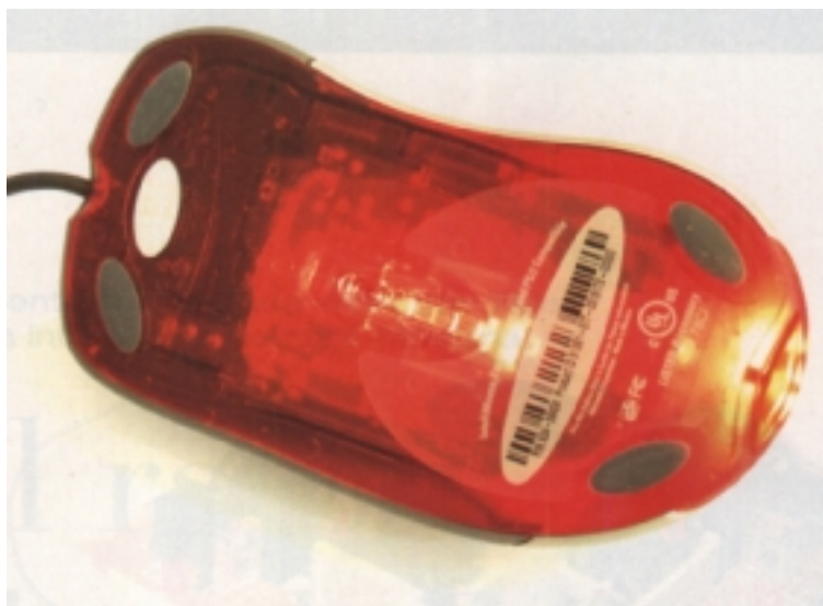
Figura 3. La ausencia de partes mecánicas hace que los ratones ópticos sean más fiables
