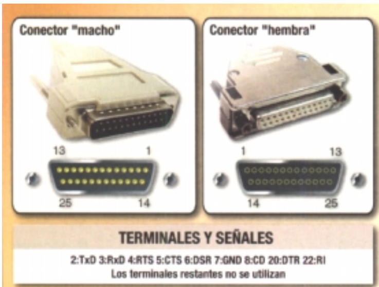
Figura 2. Conector DB-25 –en sus variantes macho y hembra- y sus correspondientes señales. Nótese que la numeración de los pines es diferente en cada variante. Las señales disponibles son las mismas que en el caso del conector DB-9
