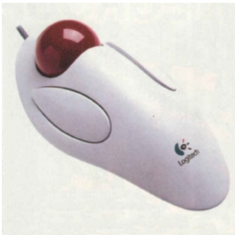
Figura 6. En un Trackball, la bola se mueve directamente con los dedos. En la imagen vemos el Marble Mouse de Logitech.
