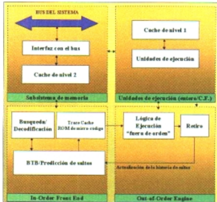
Figura 2. Diagrama de bloques general de la arquitectura NetBurst
