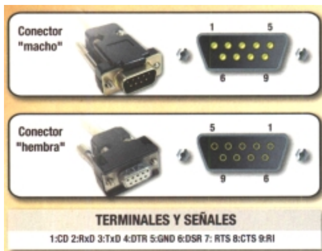
Figura 1. Conector DB9 –en sus variantes macho y hembra– y sus correspondientes señales. Nótese que la numeración de pines es diferente en cada variante
