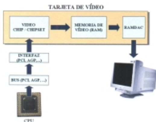
Figura 2. Estructura y funcionamiento de una tarjeta de vídeo.
