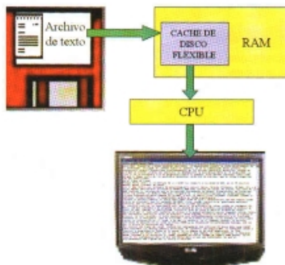
Figura 2. Primer acceso a un archivo de texto, almacenado en un disco flexible. La información no se halla en la caché del disco flexible (porción de RAM). Por ello, es necesario copiarla primero del disco a la RAM, y de ahí el retardo inicial.
