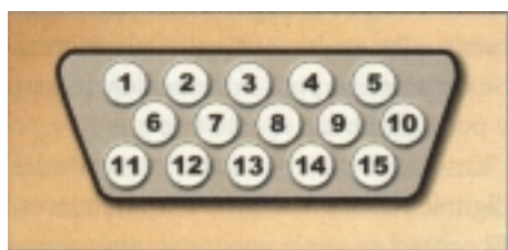
Figura 5. Conector VGA de 15 terminales.
