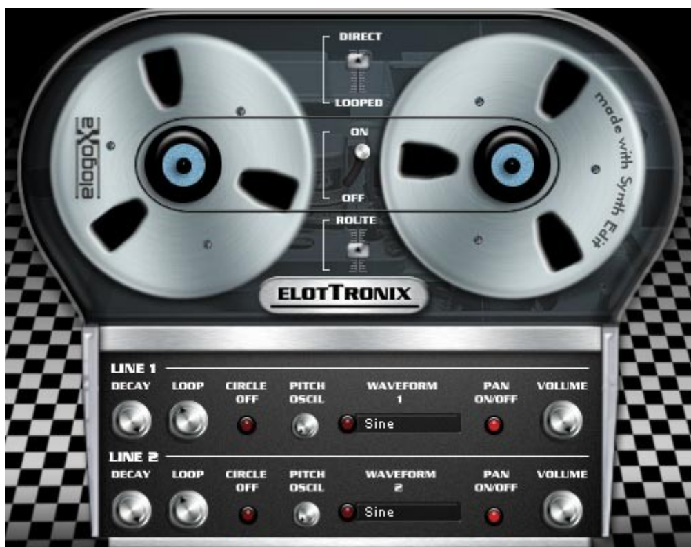
ELOTTRONIX - Procesador VST desarrollado por ELOGOXA que emula el efecto "Flippertronix" creado por Robert Fripp y que simula dos STUDER REVOX B77 haciendo un loop continuo
