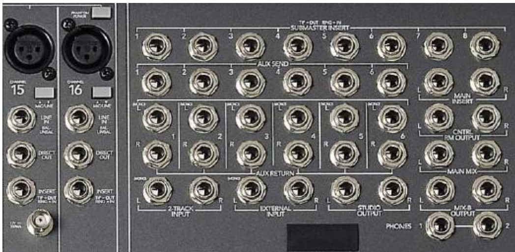
Vista de Rack de Insertos y Envíos de la Consola MACKIE 24:8 Bus Series
