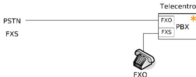
**Imagen 9:** El Telecentro usa una tarjeta TDM400P wildcard para (1) conectar la PBX a la RTB (módulo FXO) y (2) añadir una extensión al teléfono analógico (FXS module).
